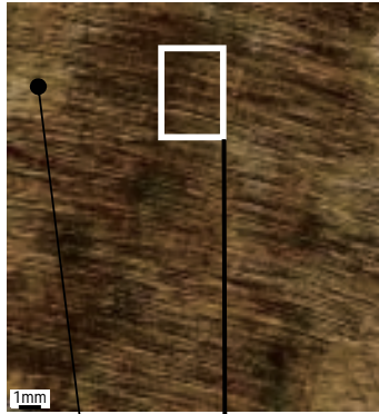
バフ施工の跡
