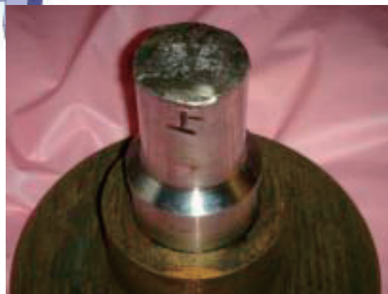
弁棒の破損状況
