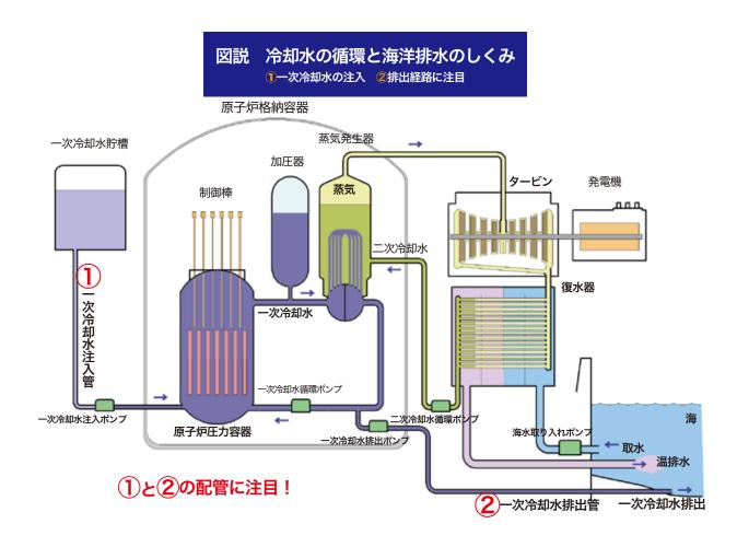
加圧水型原子炉では、制御棒を引き上げた後の出力制御は一次冷却水の中に添加した物質の調整で行います。この過程で大量の純水補給と一次冷却水の排出が行われます。このように全ての原発からは、その運転開始時から放射性物質が様々な形で環境に放出されてきましたが、人々の健康に深刻な被害を与える日常的な放射性物質を含む一次冷却水の意図的排出の説明は避けられてきました。
